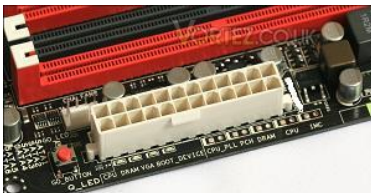
Gniazdo zasilania płyty głównej ATX
