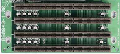
EISA – 32-bitowa wersja złącza ISA
