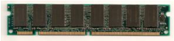
moduł SDR SDRAM – do gniazda DIMM
