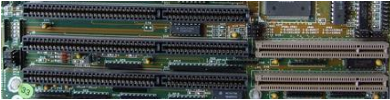
VLB – rozszerzenie złącza ISA
