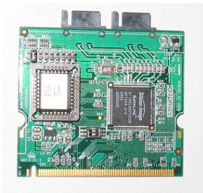
Karta rozszerzeń ze złączem miniPCI – stosowane w komputerach przenośnych
