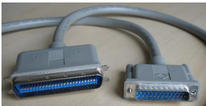
Złącze SCSI – dyski twarde, urządzenia peryferyjne
