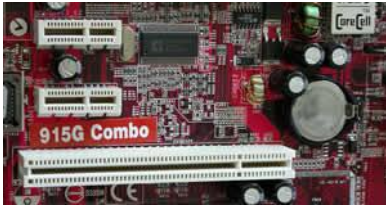
PCI-Express x1 – karty rozszerzeń, pod spodem PCI
